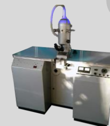
Siemens Elmiskop 51 CJ 1969 Acc.Volt. 50 kV Max. Resolution 3nm
