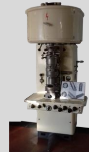
Siemens Übermikroskop ÜM 100b CJ 1951 Acc.Volt. 20-125 kV Max. Resolution 0.3nm
