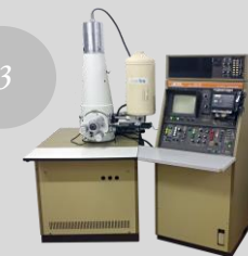
JEOL JSM – 35 CF CJ 1970 Acc.Volt. 10-30 kV Max. Resolution 10nm
