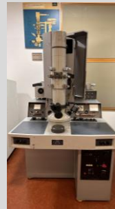
ZEISS EM 9A S-2 CJ 1967 Acc.Vol. 60 kV Max. Resolution 0.7nm
