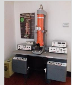
Zeiss EM 10 CJ 1980 Acc.Volt. 20-100 kV Max. Resolution 0.2nm
