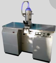
Siemens Elmiskop 51 CJ 1969 Acc.Volt. 50 kV Max. Resolution 3nm
