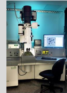
Zeiss EM 10 CJ 1980 Acc.Volt. 20-100 kV Max. Resolution 0.2nm
